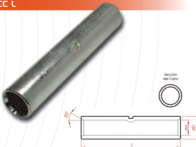
Las uniones largas, además de reunir las características generales de la línea ZCC, presentan un caño de mayor longitud el cual permite realizar doble indentación o compresión que, además de asegurar mejor superficie de contacto y adherencia, permite soportar esfuerzos de tracción aplicados al conductor.
